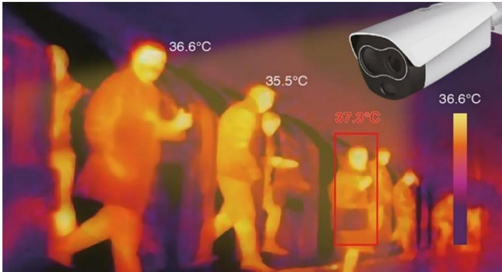
La termografía sirve para analizar la intensidad espectral infrarroja y darle un valor, basado en el análisis de la imagen, para determinar qué temperatura hay en cada persona dentro de un grupo.
