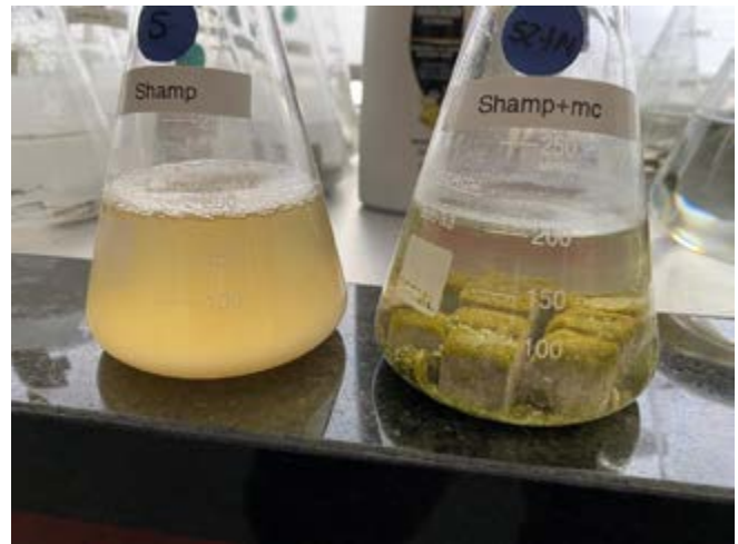
Figura 3) El material desarrollado en el Centro de Estudios de la Fotosíntesis™ Humana, S.C. comercializado bajo el nombre de QBLOCK™, clarifica eficientemente, y sin necesidad de electricidad, elementos contaminantes frecuentes, como detergentes, con poca formación de lodos tóxicos. La calidad del agua obtenida favorece la formación de carbono orgánico (zonas verdes).
